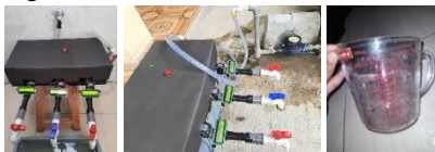
Gambar 17. Pengujian sensor waterflow
