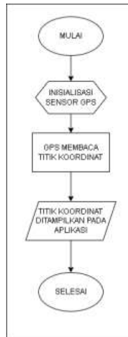
Gambar 14. Flowchart Rancangan Perangkat Lunak Pada Modul GPS
