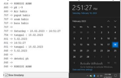
Gambar 13. Perbandingan waktu DS3231 RTC dengan waktu di laptop
