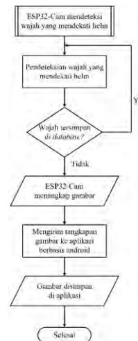
Gambar 4 Sub-proses pendeteksian wajah yang mendekati helm
