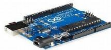
Gambar 1. Arduino Uno R3 [8]
