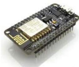
Gambar 4. NodeMCU ESP8266 [24]
