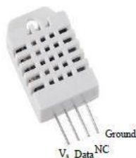
Gambar 2. Konfigurasi Kaki DHT22
