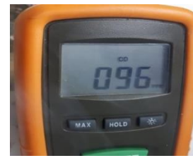
Gambar 20 Pengukuran Kadar Gas CO Menggunakan CO Meter
