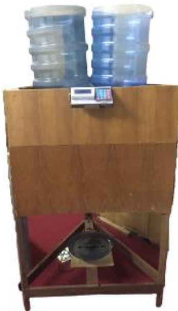
Gambar 18. Implementasi Sistem Pada Timbangan Beras Digital
