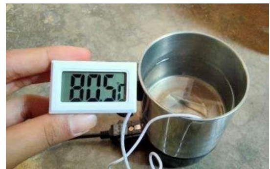
Gambar 20. Pengukuran suhu dengan menggunakan Thermometer Digital
