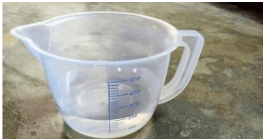
Gambar 21. Pengukuran pompa air dengan gelas ukur
