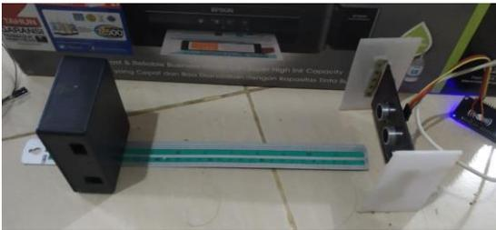
Gambar 19 Pengujian Pembacaan Jarak
